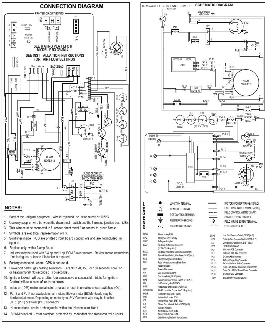
Fig. 60 – Wiring Diagram
