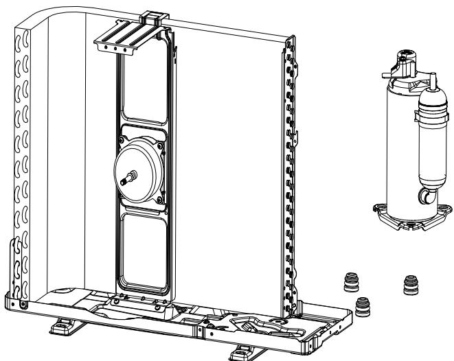
**11. Remove the fan motor and fan supporter**
