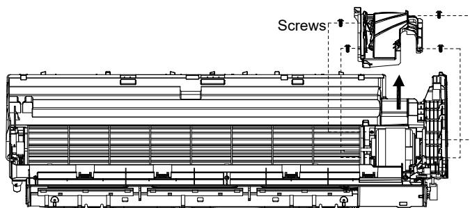
**10. Disassemble fan motor and fan blade**
