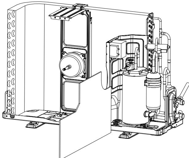
**7. Disassemble the separate plate**
