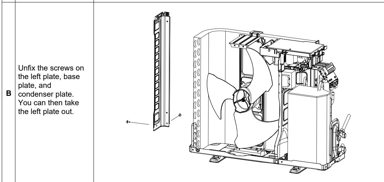
**4. Disassemble the axis fan blade**
